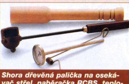
Shora dřevná palička na osekávač střel, naběračka RCBS, teploměr a míchadlo na taveninu
